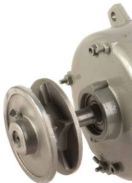
Figura 3: Ejemplo de eje con 1 grado de libertad (giro) y polea enclavada en el mismo. Eje y polea giran solidariamente.
